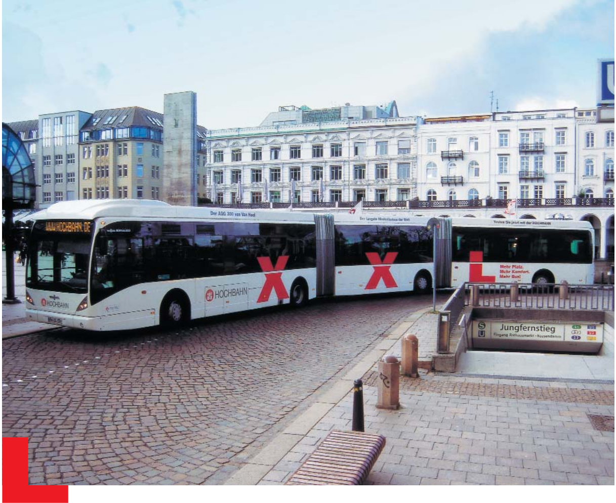
Der AGG 300 von Van Hool: Fast 25 Meter und damit 7 Meter länger als ein „normaler“ Gelenkbus.
